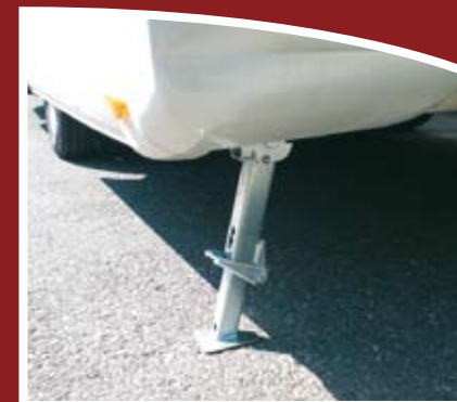
Vérins stabilisateurs Stabilité du véhicule sur tous types de terrains
