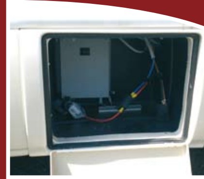
Coffre batterie avec accès extérieur Facilite l'entretien de la batterie
