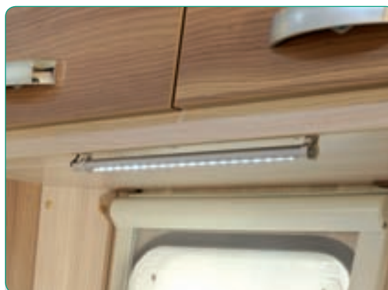
Nouvel éclairage led sous les meubles pavillon de la cuisine.
