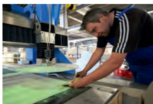
2007 Installation de découpe au jet d'eau
