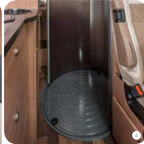
4 Beispiel Road + Freeway: Einglassene Duschwanne beim Raumbad. Mit chicer Holzabdeckung, passend zum Bodendesign, wenn nicht geduscht wird.
