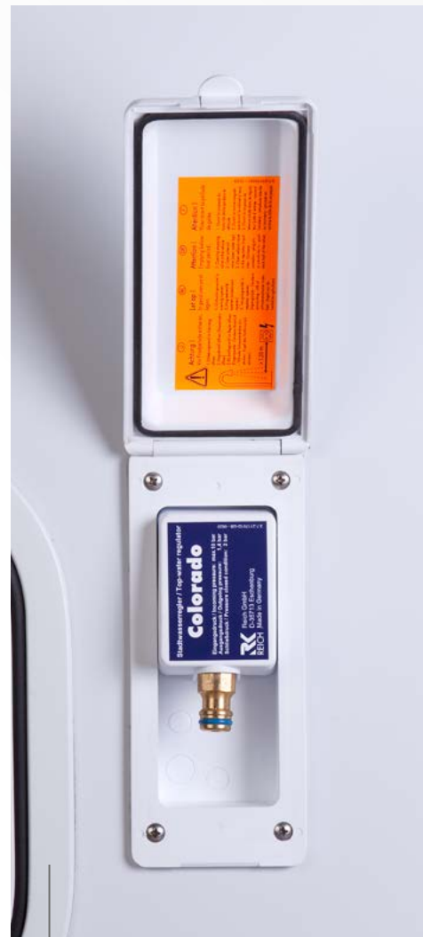
Connexion au réseau d'eau de ville
