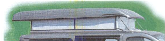
Toit levé panneaux pleins descendus
