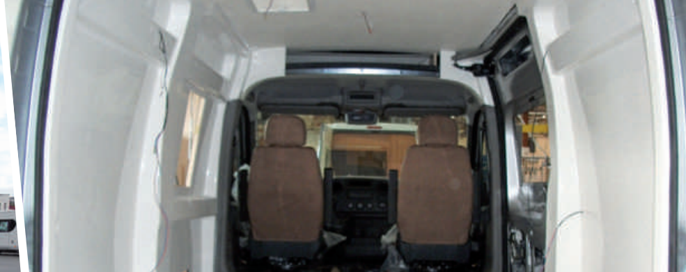
PAROI MOULÉES À LA CARROSSERIE WALLS MOULDED TO THE BODY
