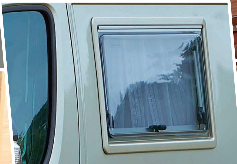
BAIE SEITZ S4 DOUBLE VITRAGE SEITZ BAY DOUBLE GLAZING
