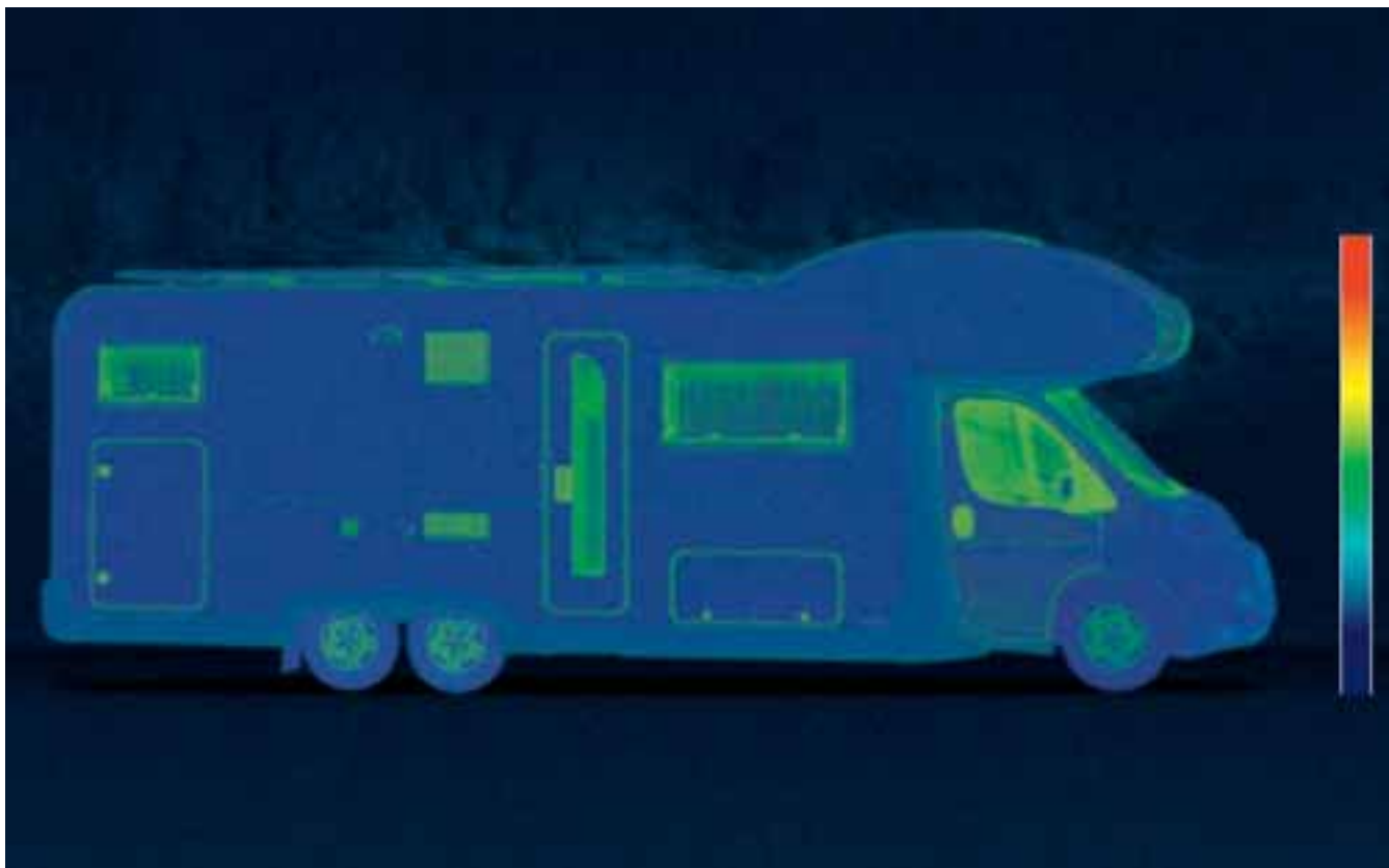
Isolation des portillons extérieurs
